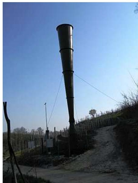
Il loro meccanismo si basa sulla creazione di onde sonore mediante emettitore di scoppi a ripetizione (ogni 10-20 secondi). La forte deflagrazione, amplificata dalla forma a megafono del cannone, propaga da terra verso l'alto una potente onda sonora che arriva fino a un centinaio di metri di altezza e che si prefigge di alterare i processi che portano alla formazione dei chicchi e alla loro caduta.
